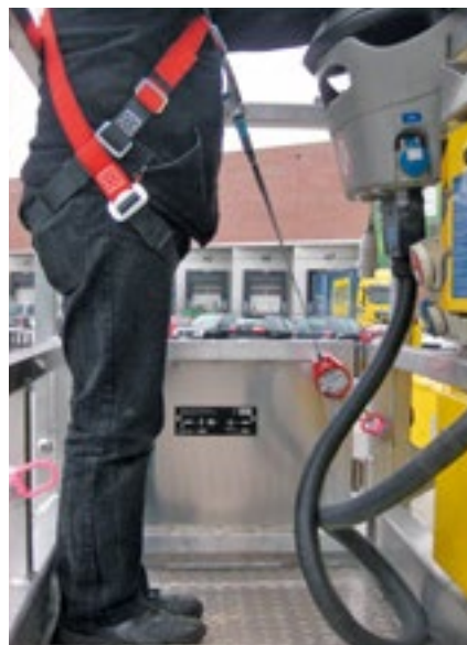
Bild 2: Simulation der Sicherung durch ein Höhensicherungsgerät mithilfe eines Dummies.
