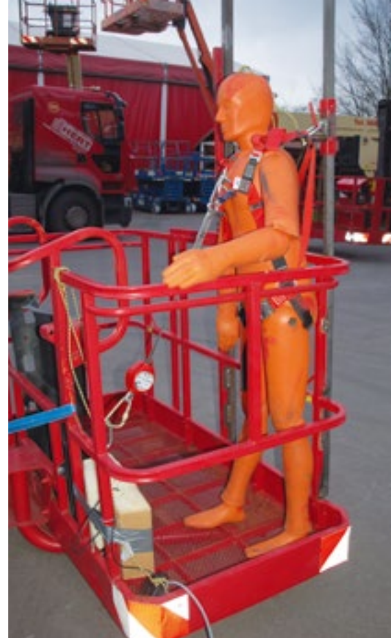
Bild 2: Simulation der Sicherung durch ein Höhensicherungsgerät mithilfe eines Dummies.
